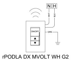
OPTION FOR NETWORKED SYSTEM. WIRELESS COMMUNICATION TO NECYD ANTENNA SHOWN ON DETAIL (1)
